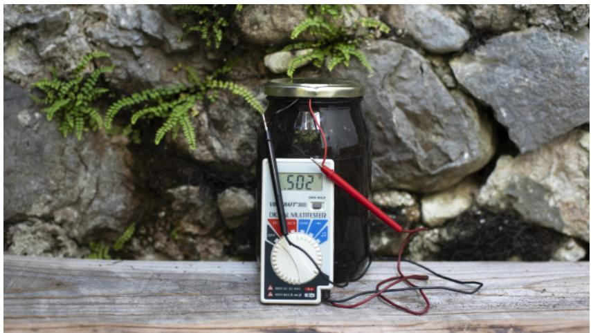
1. Switch your multimeter to direct current voltage (e.g. "DCV" depending on your device. / Na multimetu izberi funkcijo DCV oziroma V-, s katero lahko merimo enosmerno napetost (npr. v baterijah).
